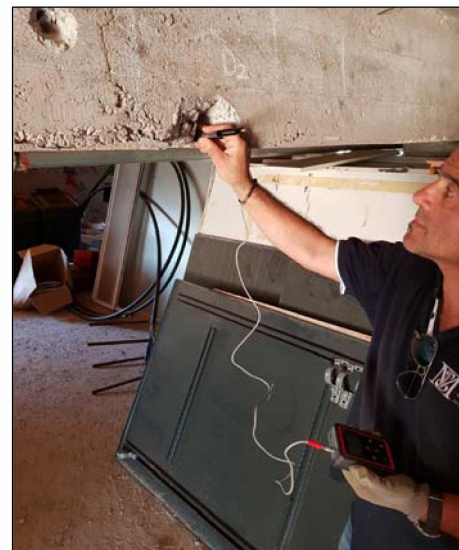
Esecuzione della prova durometrica sulla trave T5.
