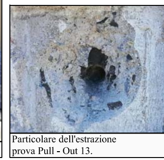
Cono estratto dalla prova Pull - Out 13 (pressione di estrazione 106 bar RcK 41,2 N/mm 2 ).
