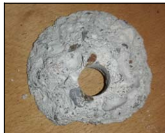
Cono estratto dalla prova Pull - Out 1 (pressione di estrazione 56 bar RcK 25,6 N/mm 2 ).
