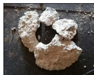
Cono estratto dalla prova Pull - Out 5 (pressione di estrazione 36 bar RcK 20,1 N/mm 2 ).
