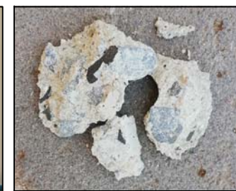
Cono estratto dalla prova Pull - Out 13 (pressione di estrazione 106 bar RcK 41,2 N/mm 2 ).
