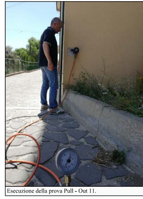
Valore manometro prova Pull - Out 11 (pressione di estrazione 85 bar RcK 35 N/mm 2 ).
