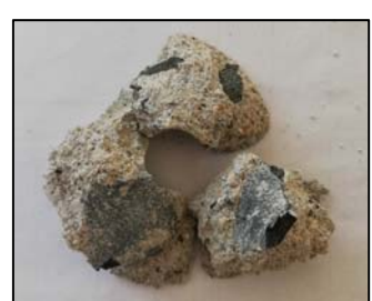
Cono estratto dalla prova Pull - Out 7 (pressione di estrazione 94 bar RcK 37,4 N/mm 2 ).
