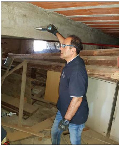
Esecuzione della prova sclerometrica sulla trave T5.
