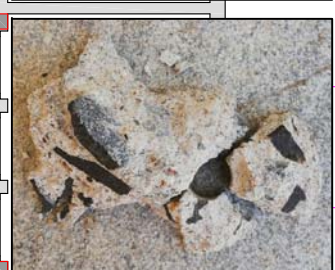
Cono estratto dalla prova Pull - Out 10 (pressione di estrazione 86 bar RcK 35,1 N/mm 2 ).
