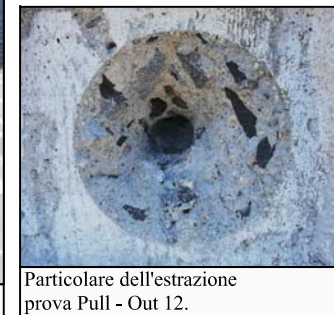
Cono estratto dalla prova Pull - Out 12 (pressione di estrazione 100 bar RcK 39,4 N/mm 2 ).
