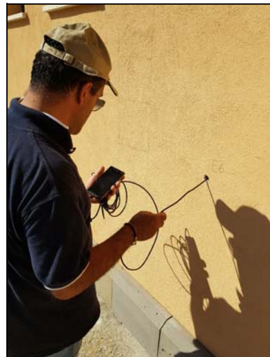
Esecuzione della prova endoscopica 6
