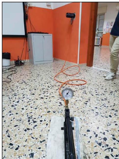
Esecuzione della prova Pull - Out 16.
