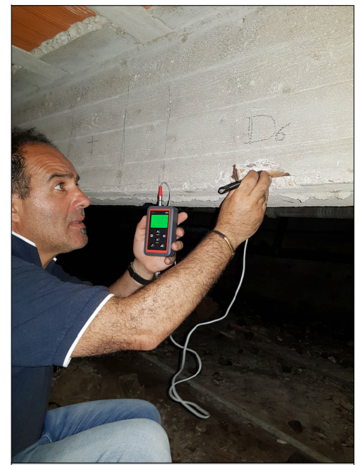
Prova durometrica D6
