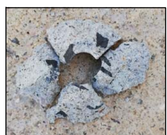
Cono estratto dalla prova Pull - Out 9 (pressione di estrazione 76 bar RcK 32,4 N/mm 2 ).
