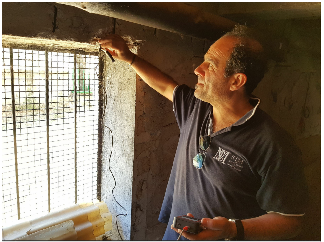
Prova durometrica D4
