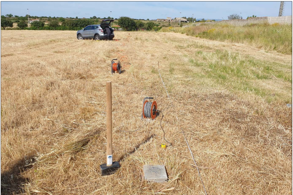
Figura 3 - Panoramica dello stendimento sismico MASW in direzione Ovest-Sud-Ovest.
