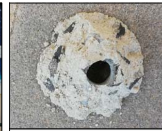
Cono estratto dalla prova Pull - Out 12 (pressione di estrazione 100 bar RcK 39,4 N/mm 2 ).
