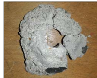
Cono estratto dalla prova Pull - Out 2 (pressione di estrazione 106 bar RcK 41,1 N/mm 2 ).
