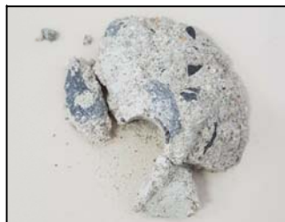
Cono estratto dalla prova Pull - Out 14 (pressione di estrazione 75 bar RcK 31,7 N/mm 2 ).
