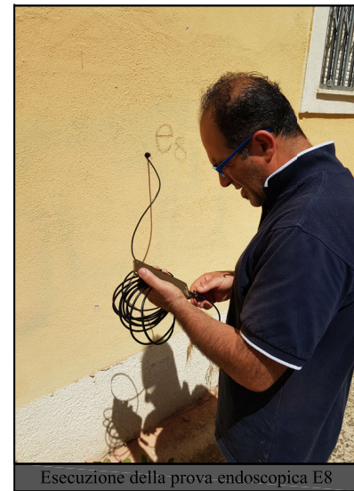
Esecuzione della prova endoscopica E8
