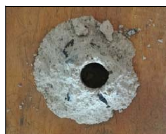
Cono estratto dalla prova Pull - Out 6 (pressione di estrazione 39 bar RcK 21,1 N/mm 2 ).
