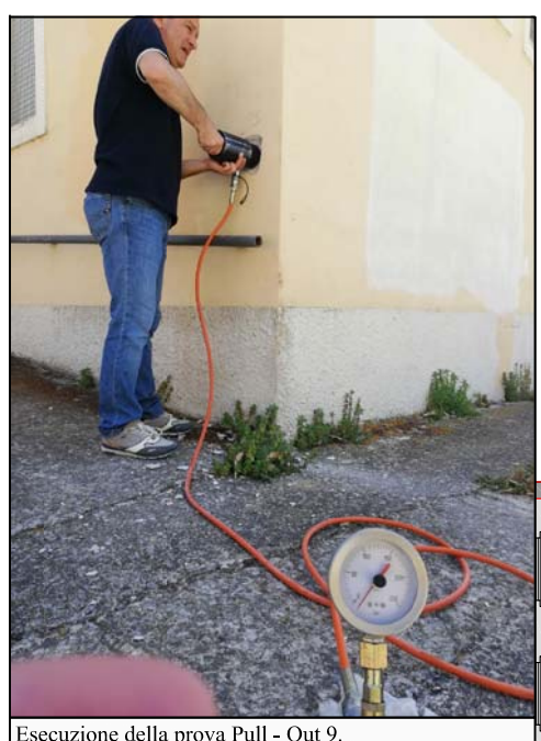
Esecuzione della prova Pull - Out 9.
