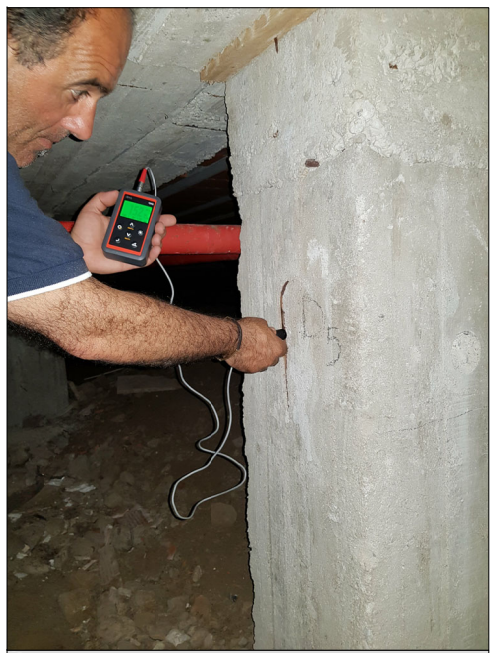
Prova durometrica D5
