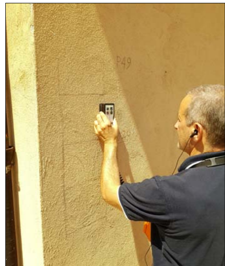
Ricostruzione schemi strutturali con ausilio dello strumento "Pachometro". Rilevati nel pilastro P49, quattro ferri longitudinali \varnothing 16 e staffe \varnothing 8/16
