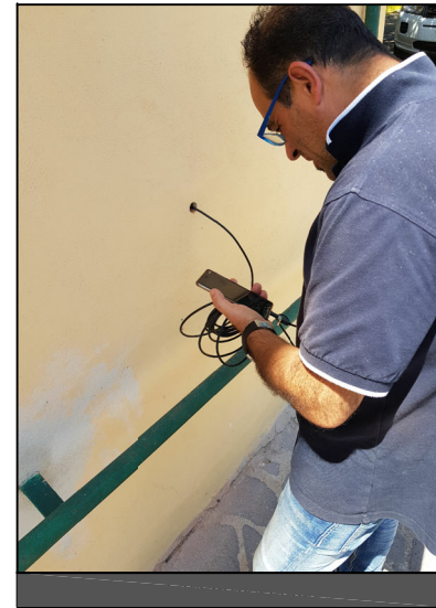
Prova endoscopica E4 - Solaio di calpestio 1° piano
