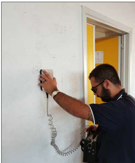
Ricostruzione schemi strutturali con ausilio dello strumento "Pachometro". Rilevati nel pilastro P27, sei ferri longitudinali \varnothing 20 e staffe \varnothing 8/20
