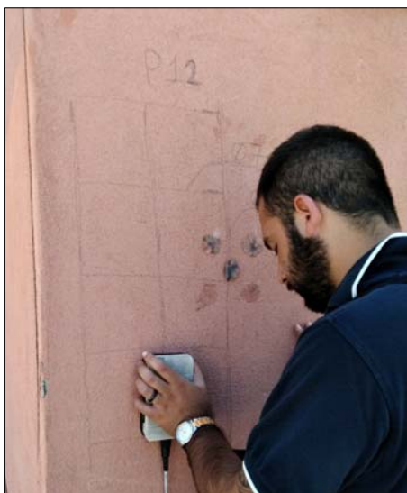
Ricostruzione schemi strutturali con ausilio dello strumento "Pachometro". Rilevati nel pilastro P12, sei ferri longitudinali \varnothing 16 e staffe \varnothing 6/16
