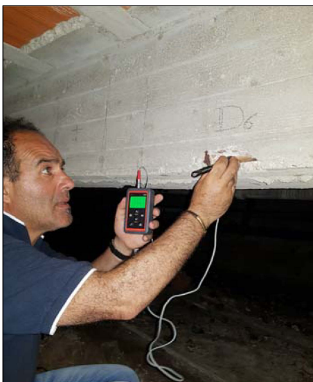
Esecuzione della prova durometrica sulla trave T3.
