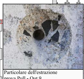
Cono estratto dalla prova Pull - Out 9 (pressione di estrazione 76 bar RcK 32,4 N/mm 2 ).
