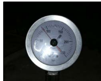
Valore manometro prova Pull - Out 3 (pressione di estrazione 87 bar RcK 35,4 N/mm 2 ).
