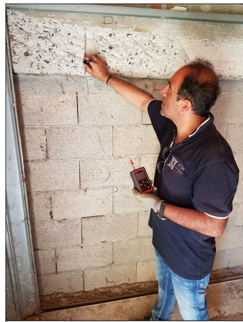
Prova durometrica D1
