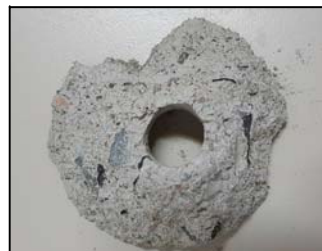
Cono estratto dalla prova Pull - Out 15 (pressione di estrazione 53 bar RcK 25,1 N/mm 2 ).
