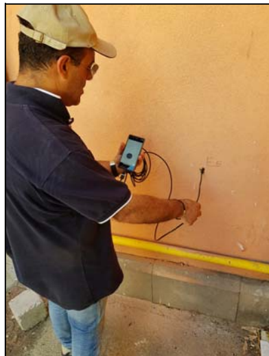
Esecuzione della prova endoscopica 5
