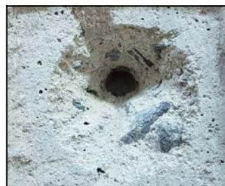
Particolare dell'estrazione prova Pull - Out 15.
