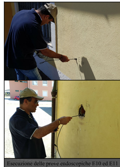
Esecuzione delle prove endoscopiche E10 ed E11
