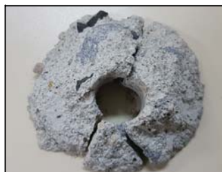
Cono estratto dalla prova Pull - Out 16 (pressione di estrazione 73 bar RcK 31,2 N/mm 2 ).
