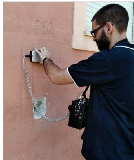
Ricostruzione schemi strutturali con ausilio dello strumento "Pachometro". Rilevati nel pilastro P52, sei ferri longitudinali \varnothing 16 e staffe \varnothing 6/18
