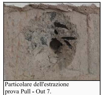
Cono estratto dalla prova Pull - Out 7 (pressione di estrazione 94 bar RcK 37,4 N/mm 2 ).
