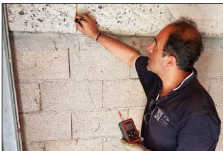
Esecuzione della prova sclerometrica sulla trave T5.
