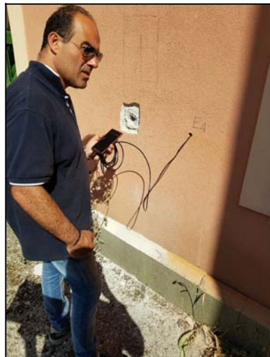
Esecuzione della prova endoscopica 4
