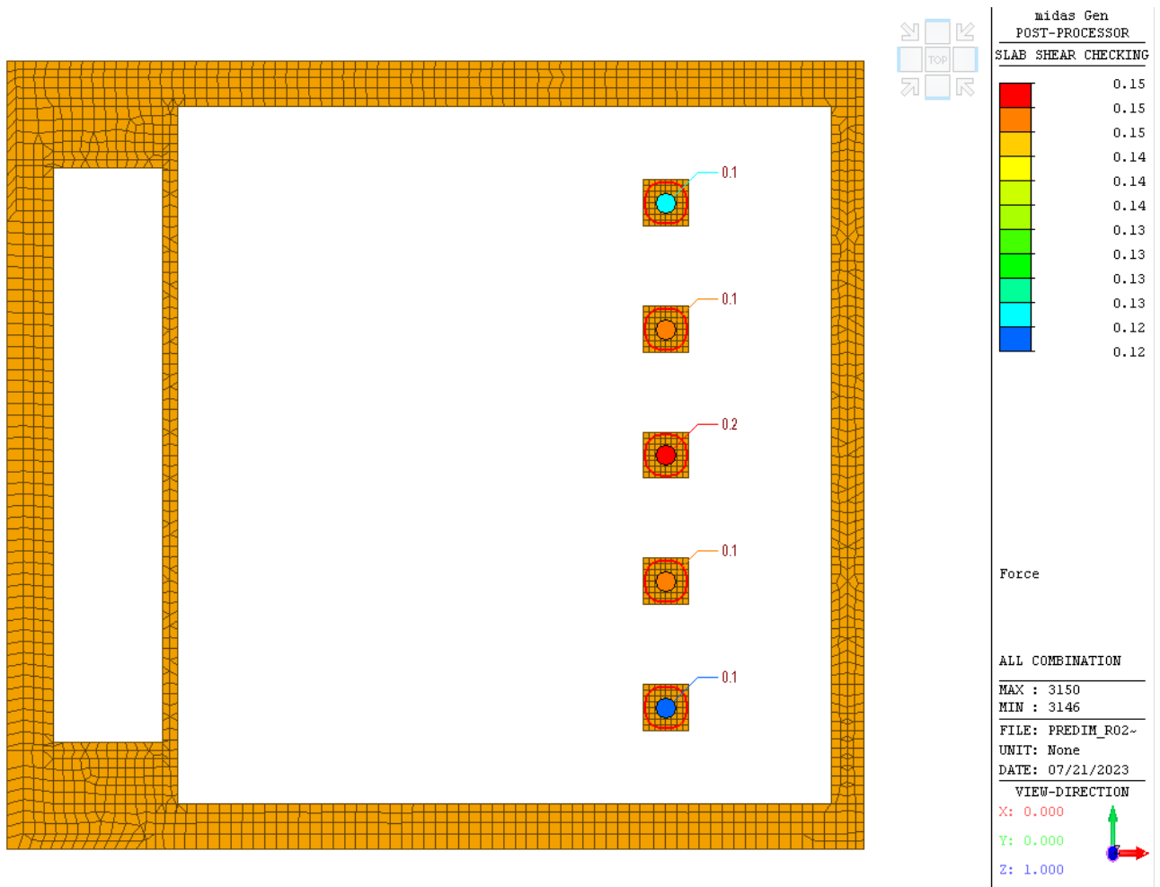
Figura 25 Verifica a punzonamento
